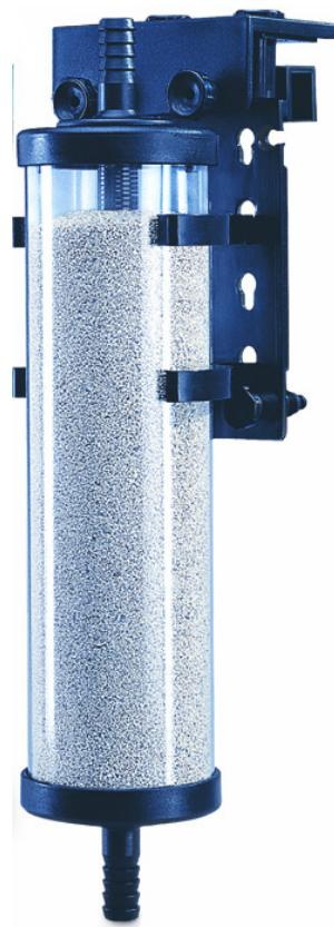
Der Aqua Medic **Phosphatfilter** ist ein anschlussfertiger Filter zur Entfernung von Phosphaten aus Süß- und Meerwasser. Phosphat entsteht bei der Zersetzung von organischen Substanzen wie z. B. Futterresten, tierischen Ausscheidungen, abgestorbenen Pflanzen, Algen und Mikroorganismen.
